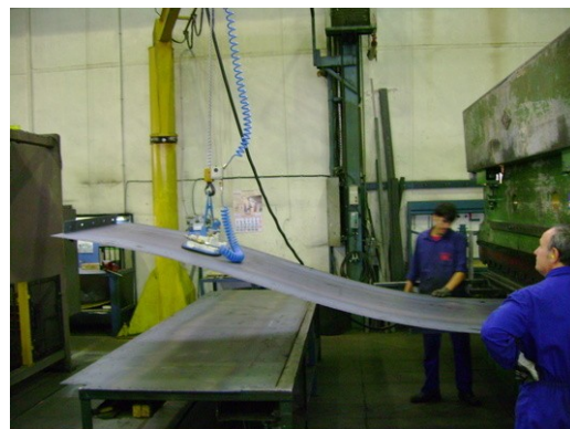
Ventosa subjectant una planxa, accionada amb aire comprimit.
