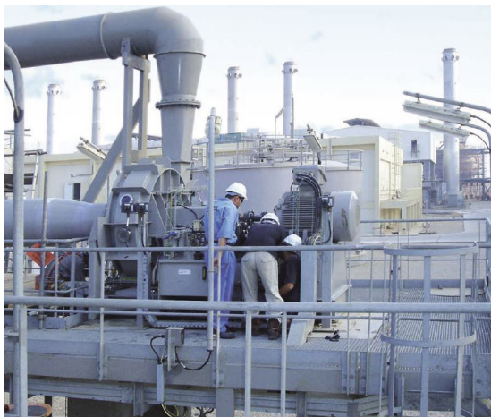
Compressor molt gran cabal Howden ExVel turbo fan (turbo radial) Motor 6.000kW Pressió superior a 1bar volum 160 \text{m}^3/\text{segon} (57.600 \text{m}^3/\text{hora} ) Foto i dades: catàleg Howden turbo fans 2014
