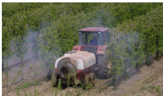
Tractor fent ús d'un compressor per poder fumigar.
