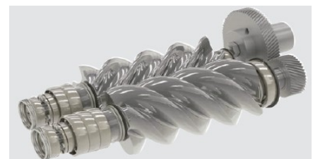
En aquesta foto es poden apreciar, en l'extrem superior de l'eix, les rodes dentades que fan girar sincronitzadament dels cargols (foto Ingersoll Rand)
